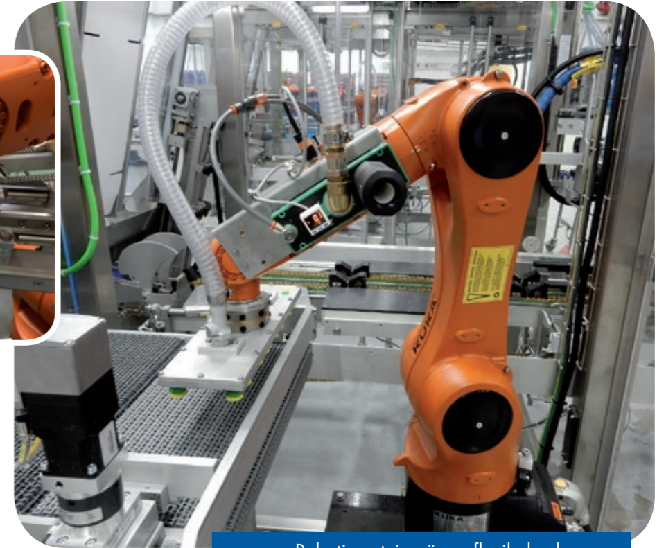
Robotinmatning är en flexibel och kompakt lösning för att lyfta, stapla och vrida produkterna in i lådan.
