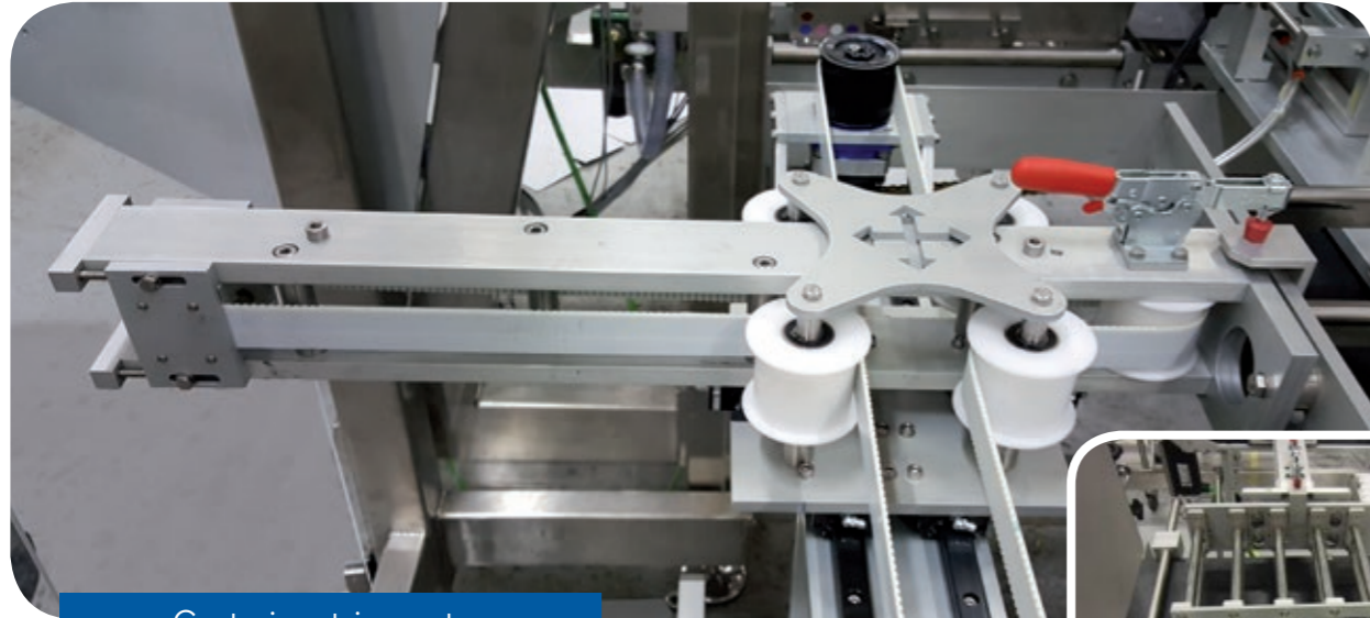
Gantry-inmatningen stegar produkten i x- och y-led i snabba och mjuka rörelser.
