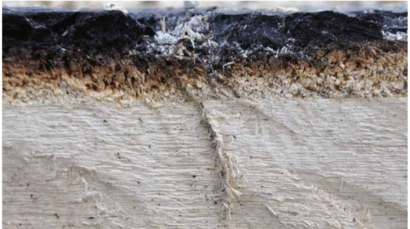
Querschnittsfläche einer Verkohlungsschicht eines 80 mm dicken CLT-Elements, ursprünglich mit Brandschutz-Gipskarton verkleidet, nach einem groß angelegten Brandversuch: Es ist leicht, die verschiedenen Schichten auf diesem Querschnitt zu erkennen: der verkohlte Bereich (schwarzer Bereich), gefolgt vom Pyrolysebereich (brauner Bereich) – verursacht durch das sich ausbreitende Feuer oder die Pyrolyse – und das unbeschädigte Holz.
