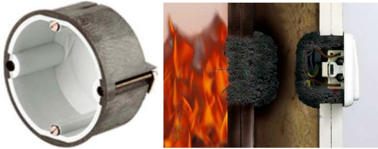
Abbildung 97: Hohlwanddose mit Dämmschichtbildner der Firma Kaiser, vor und nach Brandbeanspruchung
